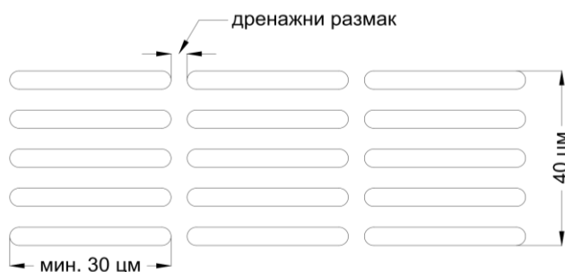
Слика/цртеж 3: дужина елемената и дренажни размак
